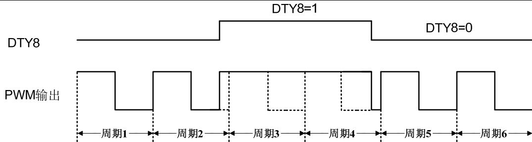
当 PWM 输出波形时，若 DTY8(PWMCR.1)改变，PWM 波形会立即改变。如上图所示，在周期 2 中使 DTY8 置 1，PWM 会立即响应，固定输出高；在周期 4 某处 DTY8 清 0，PWM 立即响应，取消固定输出。
